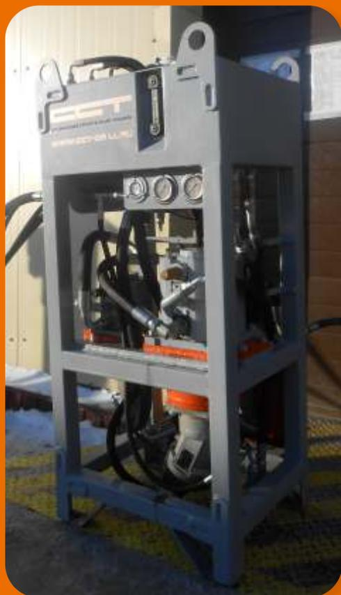
Все модели буровых установок Figaro выполнены с раздельным блоком гидростанции. Такая конструкция позволяет устанавливать гидростанцию вне стесненных помещений, тем самым, упрощая перемещения непосредственно самой буровой установки внутри сооружений. Привод строенного гидравлического насоса может осуществляться дизельным, электрическим или пневматическим двигателем в зависимости от условий эксплуатации.
